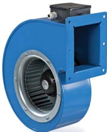
Центробежные вентиляторы одностороннего всасывания в спиральном поворотном корпусе, оснащенные двигателем с внешним ротором. Производительность – до **2000 м³/ч**. Предназначены для приточно-вытяжных систем вентиляции.
