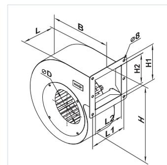
**Габаритные размеры вентиляторов:**
