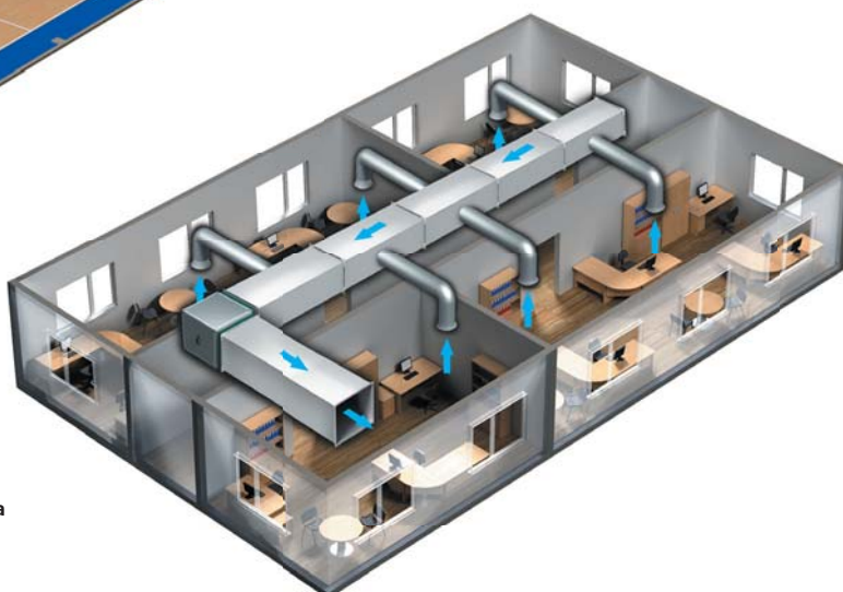
Вариант применения вентилятора ВШ в офисном помещении.
