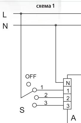
Вентилятор при помощи внешнего переключателя S (например, П3-1-300) может быть вручную включен на одну из требуемых 3-х скоростей или выключен.
