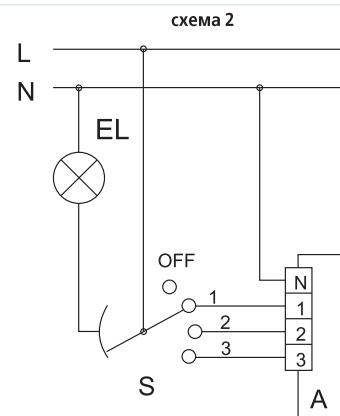
Вентилятор при помощи внешнего переключателя S (например, П3-1-300) может быть вручную включен на одну из 3-х скоростей, при этом освещение в помещении включается параллельно, или выключен, при этом освещение в помещении выключается. Вентилятор не может быть включен без освещения и наоборот.
