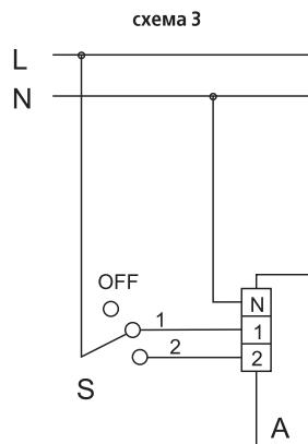
Вентилятор при помощи внешнего переключателя S (например, П2-1-300) может быть вручную включен на одну из 2-х скоростей или выключен.
