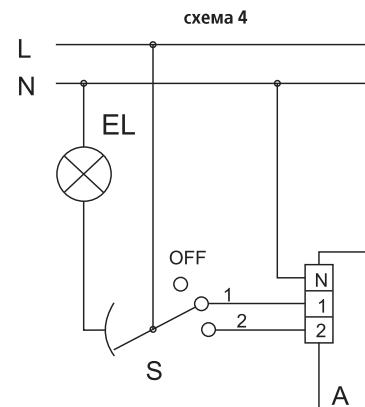
Вентилятор при помощи внешнего переключателя S (например, П2-1-300) может быть вручную включен на одну из 2-х скоростей, при этом освещение в помещении включается параллельно, или выключен, при этом освещение в помещении выключается параллельно. Вентилятор не может быть включен без освещения и наоборот.
